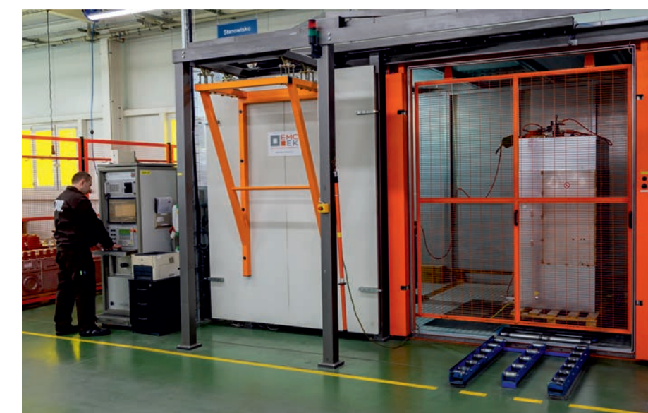
Stanowisko do prób napięciowych z klatką Faradaya.
